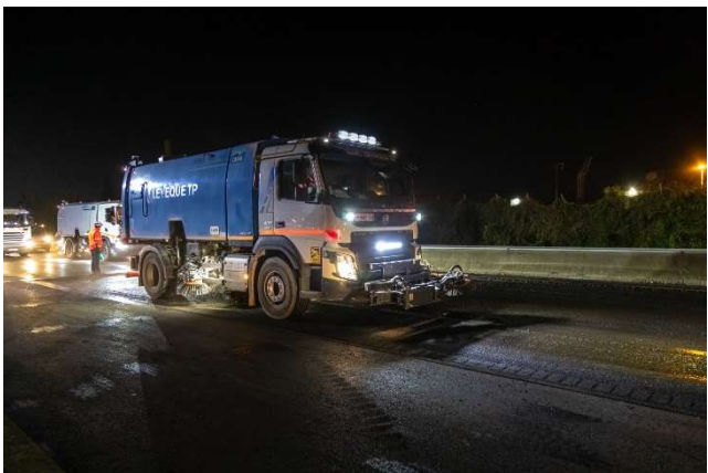
Nettoyage de la chaussée par balayuses très haute pression
